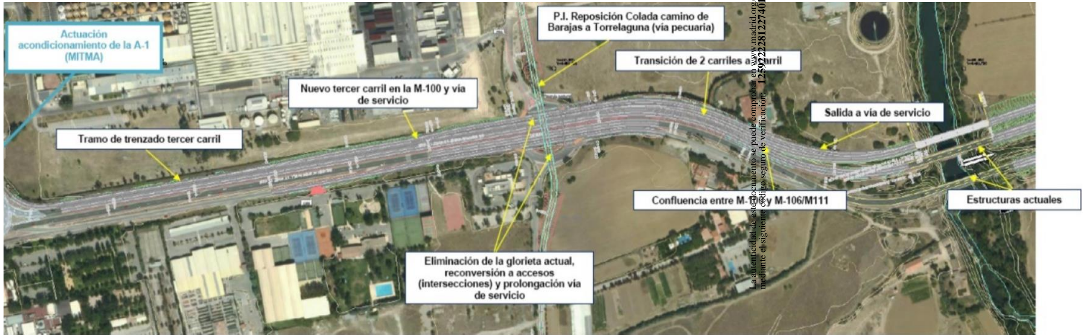
Croquis del tramo entre el río Jarama y la conexión con la autopista A-1, tramo común a todas las alternativas. Fuente: EsIA
