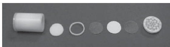
Figura 15. Elementos del captador pasivo Ogawa. (Fuente: Manual Radiello).
